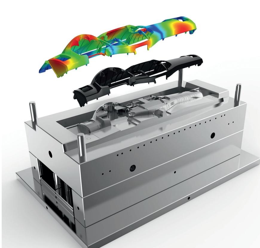
**Potenzial visualisieren:** Mithilfe einer Analyse der Prozess- und Bauteilsimulation (hier mit Moldex3D) können Eigenspannung, Schwindung und Verzug dargestellt und optimiert werden. (© SimpaTec)
